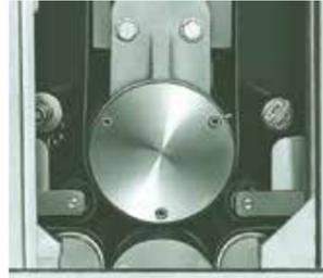
プリント基板(多層板)のバリ取り・平面研磨に最適です。
