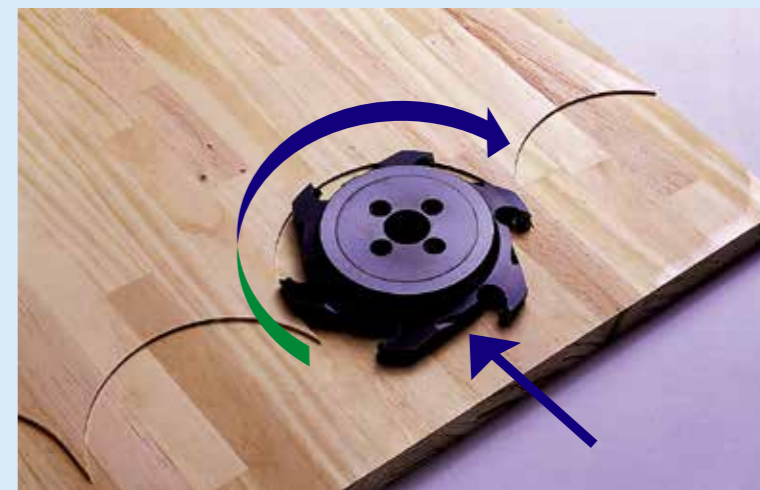
写真はスローアウェイ式カッター（チップの交換によりカッターの再研磨不要）
