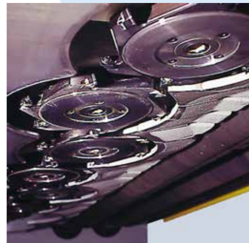
写真はスローアウェイ式カッター（チップの交換によりカッターの再研磨不要）
