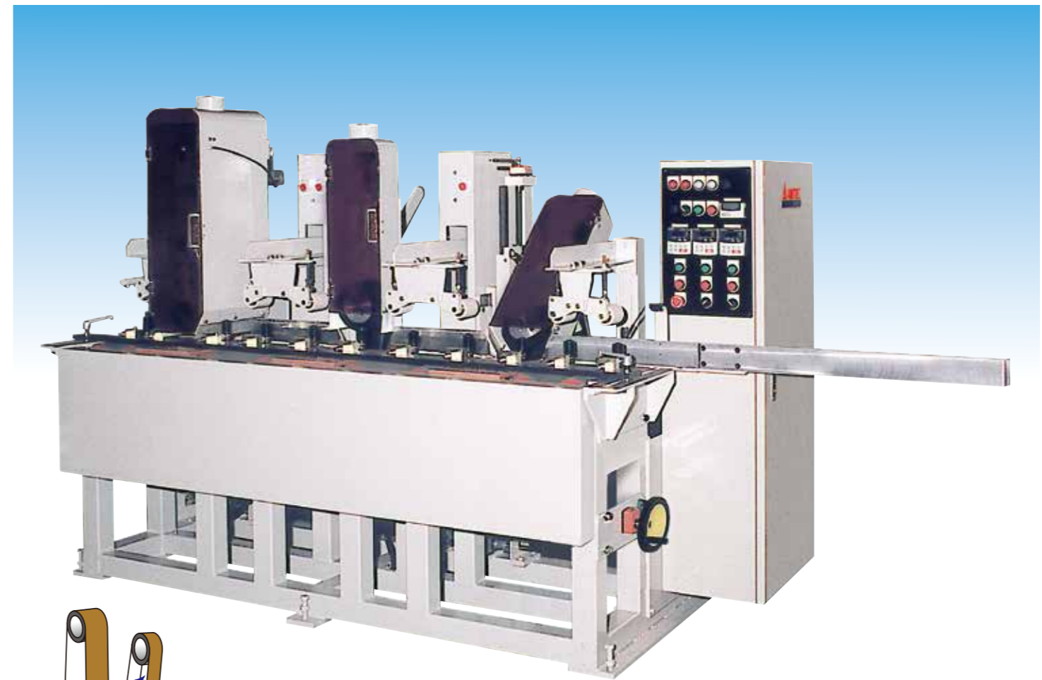
3M15S3 サンディングヘッド傾斜角度：第1=+45~-45°, 第2=0~90°, 第3:固定 別注:昇降ハンドルデジカウンター付
