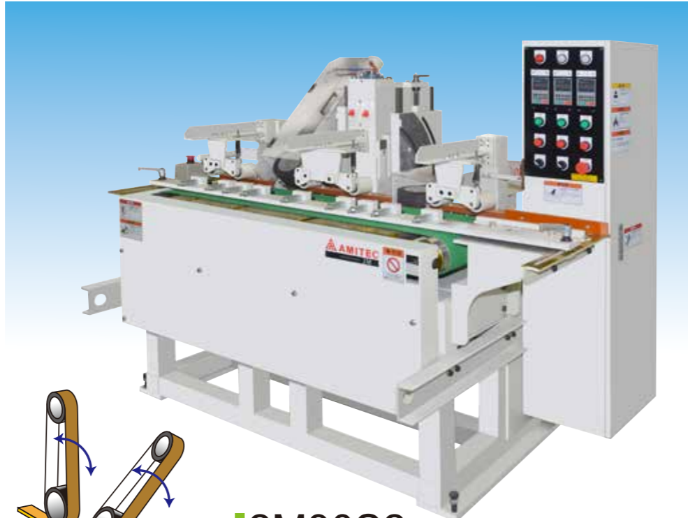
2M30S2 サンディングヘッド傾斜角度：第1, 第2=0~90°
